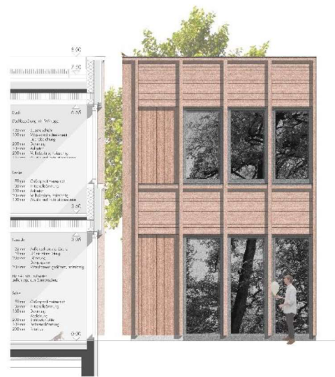
Fassadenschnitt und reliefierte MA 20
